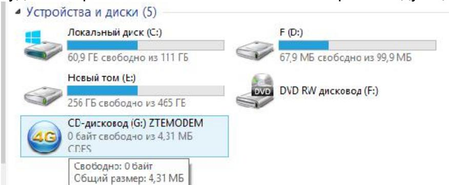
3. Если программа автоматической установки ПО не запустилась, дважды кликните на CD-дисковод ZTEMODEM.
