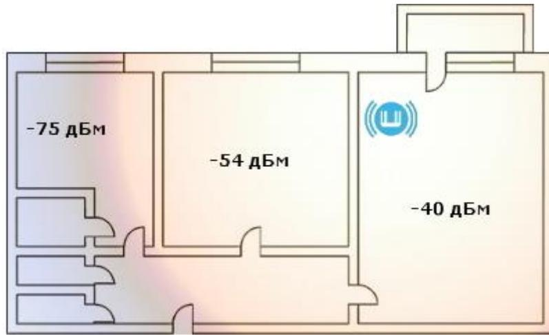
Измерение сигнала выполнено в комнате с роутером в двух метрах от него в прямой видимости. Помех на пути прохождения сигнала нет. Сила сигнала -40 дБм, канальная скорость 150 Мбит/с.
